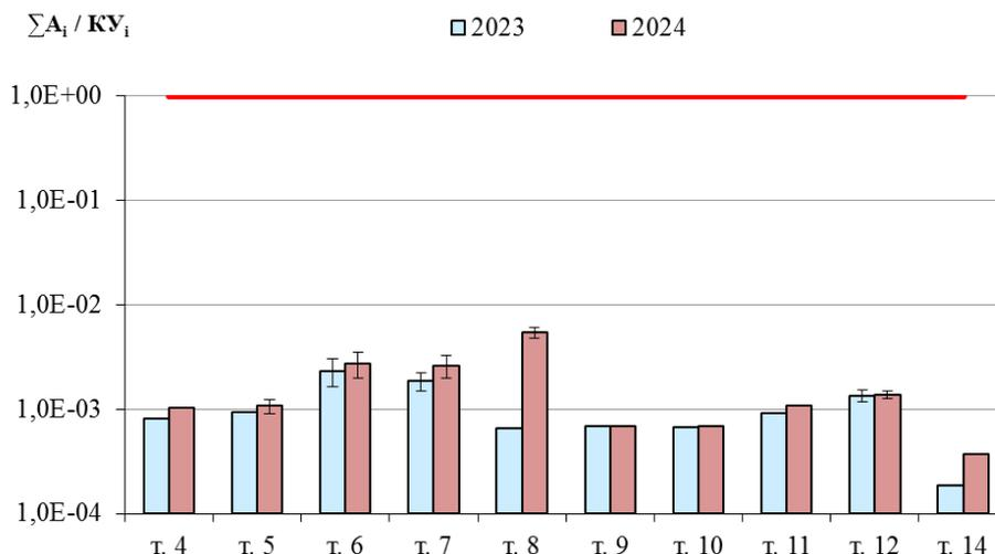
Рис. 3.12.4. Распределение интегрального показателя загрязнения открытых водных объектов (ручьев) в СЗЗ ГХК в 2023 и 2024 гг.
