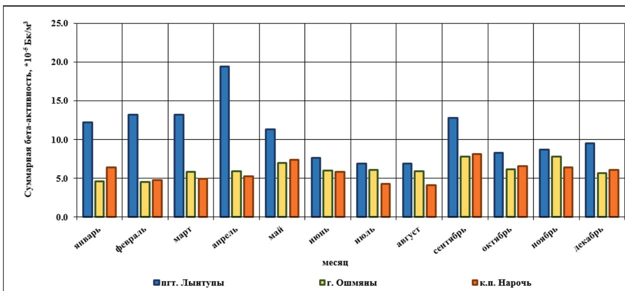
Рис. 5.4. Среднемесячные значения суммарной бета-активности в пробах аэрозолей на пунктах наблюдений в районе размещения Белорусской АЭС, 2024 год
